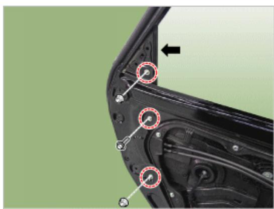
7. 拆卸后门窗玻璃固定孔塞(A)。
