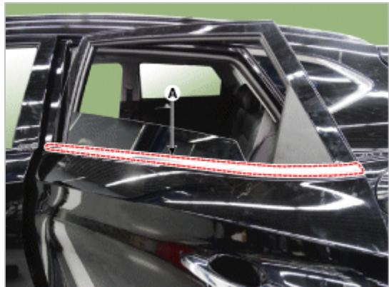
5. 完全拧下后车门导槽固定螺栓，在没有拆卸后车门板情况下，尽可能多地拧松螺母。
